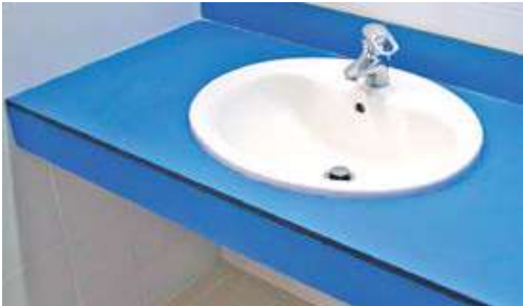
BL6013ATH Bancadas de Lavatórios Bancada de lavatório em fibra fenólica com 12 mm de espessura e 60cm de profundidade, suportes de aço inox fabricados em tubo de 60x30mm eletropolido. Lavatório não incluído. Sink Countertops Sink countertop made of 12mm thick compact laminate. 60cm depth. Brackets made of stainless steel electropolished tube (60x30mm) . Sink not included.
