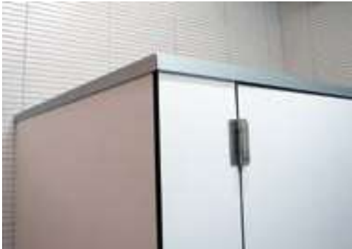
CB15 Perfil de Alumínio Anodizado Superior Alumínio extrudido. Anodizado a 15 micron. Para fixar painel superiormente. Utilizado nas frentes das cabines e nas laterais de topo. Superior Anodized Aluminum Profile Extruded aluminum. Anodized 15 micron. To fix panels on its top. Used on the front of the cabins and on the side-ends.
