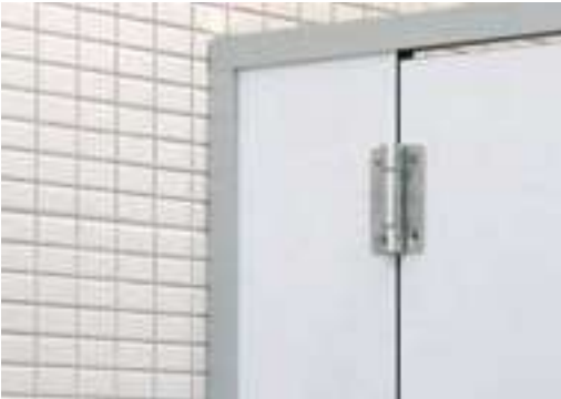
CB16 Perfil de Alumínio Anodizado Vertical Alumínio extrudido. Anodizado a 15 micron. Para fixação dos painéis à parede e laterais. Vertical Anodized Aluminum Profile Extruded aluminum. Anodized 15 micron. To fix panels to the wall and side-ends.
