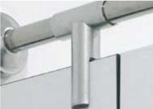
CB9 Suporte superior em Aço Inox Fabricados em aço inox eletropolido. Para fixar a parte superior do painel. Utilizado nas frentes das cabines e nas laterais de topo. Stainless Steel Superior Support Made of electropolished stainless steel. To fix the top of the panel. Used on the front of the cubicles and on the side-ends.
